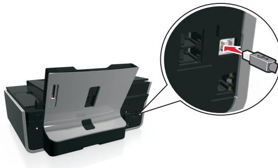
**3** 将 USB 电缆上长方形的一端牢固地插入计算机的 USB 接口中。
