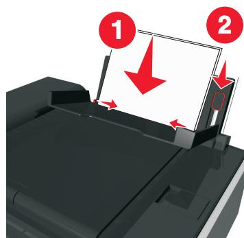
**注意：**请不要用力将纸张塞入打印机内。纸张应该平整地放置在纸张支架的表面上，并且纸张的边缘应该紧靠两边的进纸导轨。
