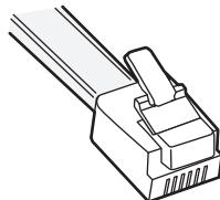
打印机后面的传真插口和随同打印机一起提供的电话线都是 RJ-11 的。如果您所在的国家或地区使用不同类型的插座，您可能需要使用 RJ-11 适配器。
