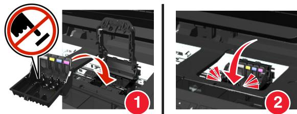
**注意：**请确保将打印墨盒安装到打印头。如要获取更多的信息，请参阅用户手册中的“更换打印墨盒”一章。
