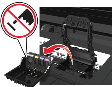
**5** 装入支持的打印头，然后关闭保护盖，直到其咔嗒一声，卡入到位。
