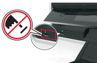
**警告—可能的损坏:** 从存储设备进行打印、读取或写入时，切勿触摸区域中所示的任何开放式连接器、存储设备或打印机。可能会发生数据丢失。
